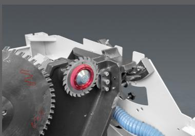
Het zware, gietijzeren zaagaggregaat draait op grote schepels. Het systeem is onderhoudsvrij en waarborgt levenslange nauwkeurigheid en soepele bewegingen. Het toerental is eenvoudig te veranderen. Er is een ruim aanbod aan motorvermogenen.
