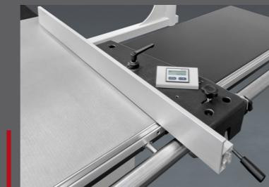
Robuuste gietijzeren parallelleider met fijnregeling voor een nauwkeurig zaagresultaat. De optionele digitale aflezing verhoogt het gebruiksgemak en de nauwkeurigheid (+ - 0.1mm). Voor de verwerking van extra grote platen kan de aanslag eenvoudig onder het tafeloppervlak worden gedraaid.
