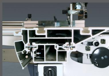
Zeer brede, volledig geanodiseerde rolwagen. Het Robland lagersysteem met harde kogels en geharde stalen ronde baren met automatisch reinigingssysteem zorgt voor een soepele loop. Het ontwerp van de profielen zorgt voor een zeer hoge torsie- en vormstijfheid, waardoor de rolwagen probleemloos jarenlang zware lasten kan dragen.
