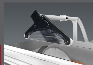
Voor een optimale veiligheid en stofzuiging past de overhangende zaagkap zich automatisch aan in functie van de hoogte van het werkstuk. De arm is eenvoudig weg te draaien. De schuinstaande steunarm (bij X1 en X3) laat het doorzagen toe van langere werkstukken met een breedte tot 850 mm.
